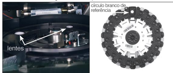
8. Usando um lenço óptico seco, seque as lentes e o círculo branco de referência, garantindo que todos os sinais de umidade tenham evaporado dos componentes limpos. Se ainda houver sinais de sujeira ou manchas, repita o processo de limpeza.
