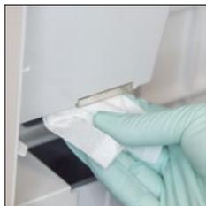
3. Remova o suporte do cartucho, limpe-o com um novo lenço com álcool, seque-o com um novo tecido óptico seco e então reserve.
