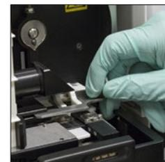
10. Remova o filtro do ventilador, lave-o bem com água morna, seque-o com uma toalha de papel e devolva-o para sua posição no analisador.
