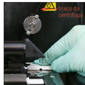
8. Usando um novo lenço de preparação de álcool, limpe o braço de movimento e, depois, seque-o com um novo tecido óptico seco.
