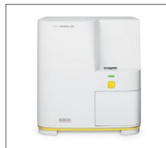
1. Abra a porta do analisador. Em seguida, após vestir luvas, use um tecido óptico para absorver a urina na parte superior do cartucho.
