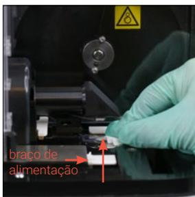
5. Usando um novo lenço de preparação de álcool, limpe a janela óptica usando um movimento circular (3 a 4 vezes), depois seque-a em movimentos circulares com um novo tecido óptico seco.
