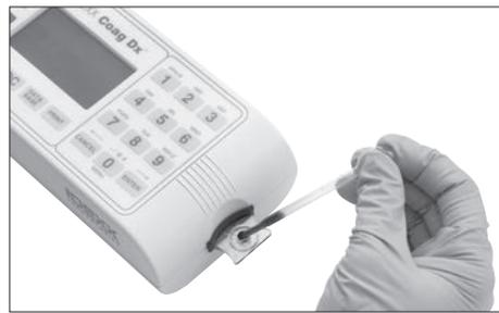
**Figura 4-10:** Adicione a amostra ao centro da cavidade
