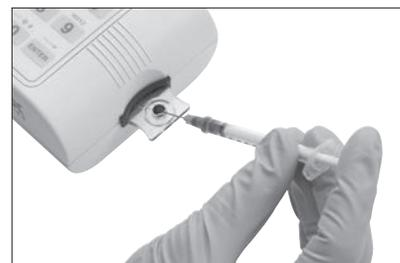
**Figura 4-2:** Adicione a amostra ao centro da cavidade
