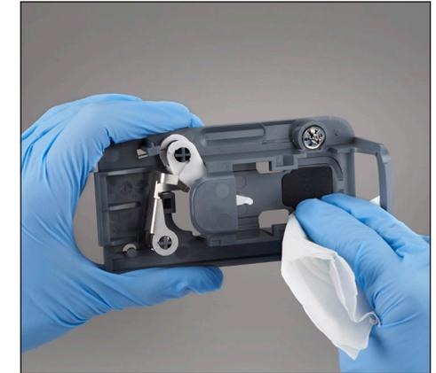
4. Limpe  **toda a** base usando um pano sem fiapos ou cotonete embebido em álcool isopropílico a 70%, sabão líquido neutro e água, ou uma solução de alvejante a 10%.
