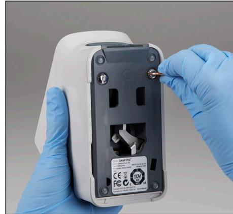
2. Na parte inferior do analisador desligado, use uma chave de fenda de ponta achatada ou uma moeda para girar os dois fixadores de prata um quarto de volta no sentido anti-horário.
